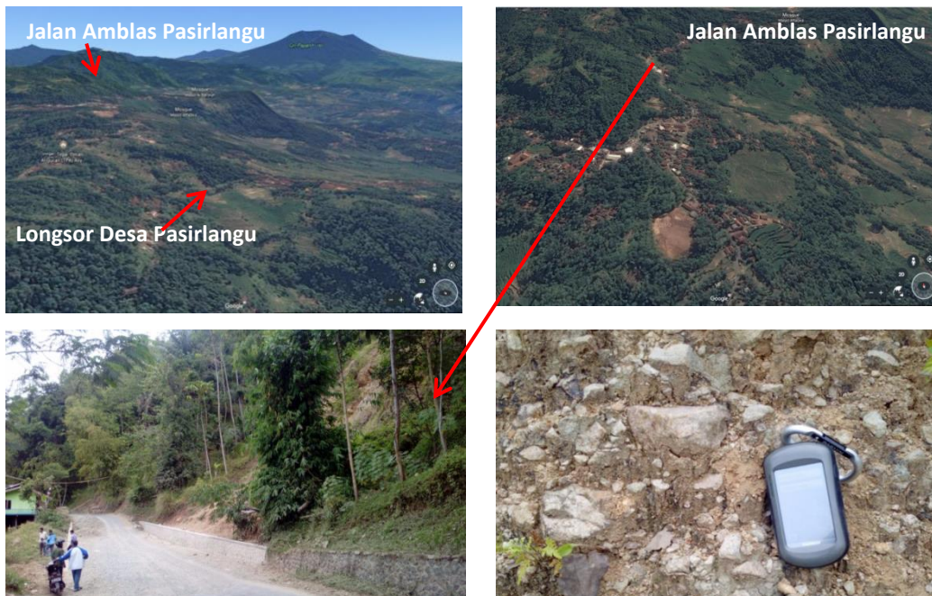
Gambar 4.1. Lokasi longsor Pasirlangu, berurutan dari kiri atas ke kanan bawah (1) Topografi tebing longsor jalan amblas Pasirlangu. (2) Desa longsor Pasirlangu (sumber : Google Earth). (3) Tampak samping dengan kemiringan lereng hampir 45 derajat. (4) Satuan batuan terdiri dari breksi dan tufa pasir lapuk cukup rentan pergerakan tanah.
